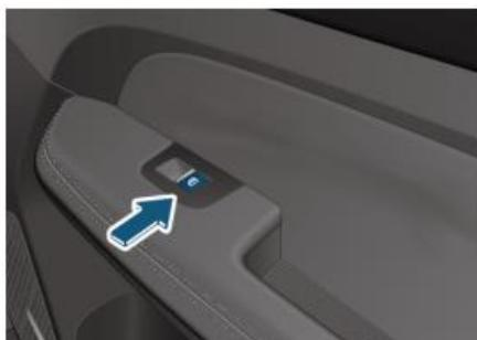
Управление стеклоподъемником с помощью клавиши на двери пассажира доступно при включенном зажигании (положение «ON»).
