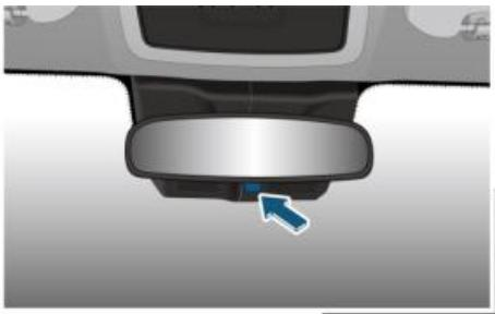
Если свет автомобиля, следующего сзади, слишком яркий, можно отклонить зеркало за рычажок в нижней части корпуса внутреннего зеркала заднего вида, чтобы предотвратить ослепление водителя.
