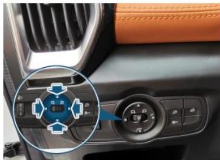
**Складывание наружных зеркал заднего вида с электроприводом\***
