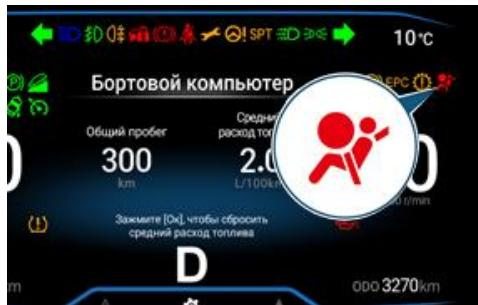
В автомобиле имеется сигнальная лампа, предупреждающая водителя о неисправном состоянии системы подушек безопасности. Подробная информация содержится в разделе «Оборудование автомобиля и управление», пункт «Сигнальные и контрольные лампы». [☞](#) стр. 26
