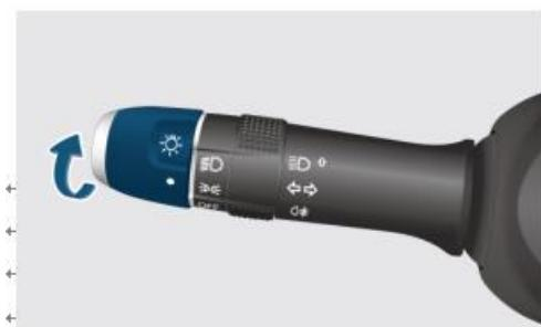
Поворотом переключателя освещения в положение включаются габаритные огни, подсветка комбинации приборов и органов управления, фонари подсветки номерного знака, а также загораются контрольные лампы комбинации приборов.
