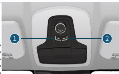
Управление панорамным люком в крыше доступно при включенном зажигании (положение «ON»).
