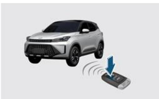
В радиусе действия дистанционного управления, когда зажигание выключено (положение «OFF») и двери закрыты (включая крышку багажного отсека), нажмите кратко кнопку запирания на пульте дистанционного управления ключа, все двери запираются, однократно прозвучит сигнал и мигнут указатели поворота.
