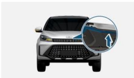
2. Подсуньте пальцы под край в средней части капота и приподнимите предохранительный рычаг замка и поднимите капот.
