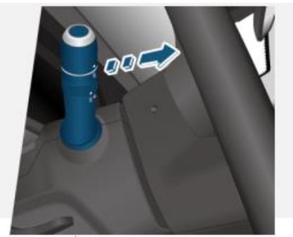
Потяните переключатель освещения назад в крайнее положение в направлении рулевого колеса, включится дальний свет. После отпускания переключатель освещения автоматически возвращается в исходное положение и дальний свет выключается. Чтобы подать световой сигнал при обгоне, потяните переключатель освещения назад и отпустите.
