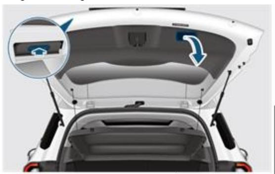
Потяните крышку багажного отсека вниз к облицовке заднего бампера, а затем крепко прижмите крышку багажного отсека обеими руками для закрывания.
