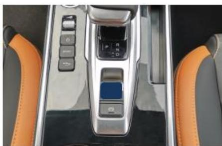
При положении «P» или «N» рычага селектора потяните вверх клавишу электромеханического стояночного тормоза (EPB). При этом загорится светодиод на этой клавише, и на комбинации приборов загорится индикатор стояночного тормоза **(P)**, указывая на то, что стояночный тормоз активирован.
