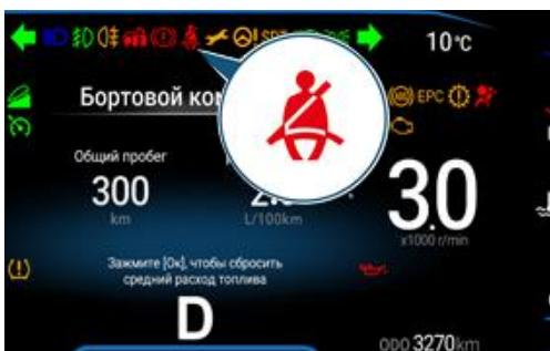
В этом автомобиле имеется сигнальная лампа непристегнутого ремня безопасности водителя и пассажиров, а также звуковой сигнализатор для напоминания о необходимости пристегнуть ремень безопасности. Подробная информация содержится в разделе «Оборудование автомобиля и управление», пункт «Сигнальные и контрольные лампы». стр. 26
