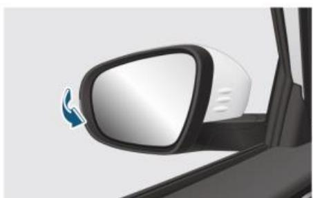
При необходимости наружные зеркала заднего вида можно сложить вручную. Нажмите на наружное зеркало заднего вида в направлении к задней части автомобиля и сложите его.
