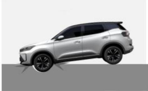
◊ Удар передней частью автомобиля о землю при въезде в глубокую канаву
