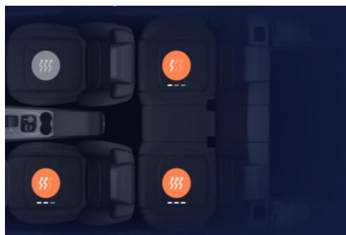
При включенном зажигании (положение «ON») и работающем двигателе нажмите кнопку подогрева сидений, чтобы включить или выключить функцию подогрева соответствующего сиденья.
