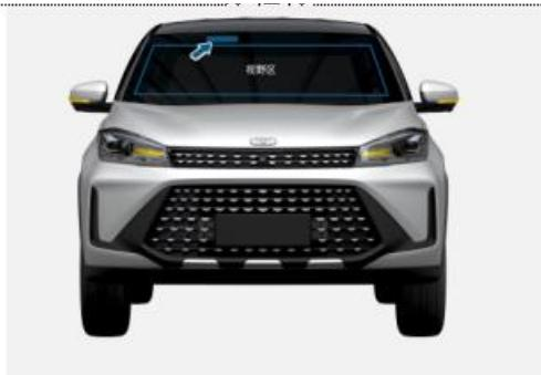
Черная рамка ветрового стекла и область за пределами поля зрения водителя могут использоваться для установки метки радиочастотной идентификации автомобиля, предпочтительно со стороны переднего пассажира (область, указана стрелкой).
