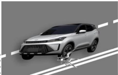
Если во время движения автомобиля произошло резкое падение давления вшине, удерживая рулевое колесо обеими руками старайтесь не допустить самопроизвольного отклонения от курса. Осторожно нажимайте на педаль тормоза для постепенного замедления автомобиля, сохраняя прежнее направление движения. Остановите автомобиль и замените колесо при необходимости.
