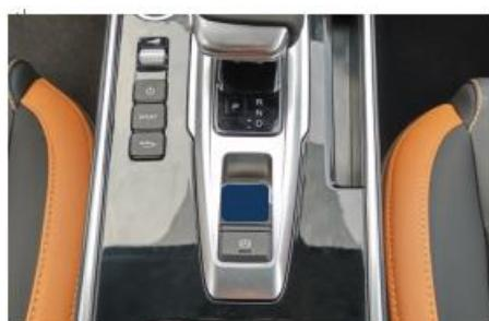
При включенном зажигании (положение «ON»), когда рычаг селектора находится в положении «P» или «N», нажмите педаль тормоза и нажмите на нижнюю часть клавиши электромеханического стояночного тормоза EPB. При нажатии на нижнюю часть клавиши электромеханического стояночного тормоза гаснут индикатор в клавише и контрольная лампа стояночного тормоза **(P)** в комбинации приборов, что указывает на выключение электромеханического стояночного тормоза.
