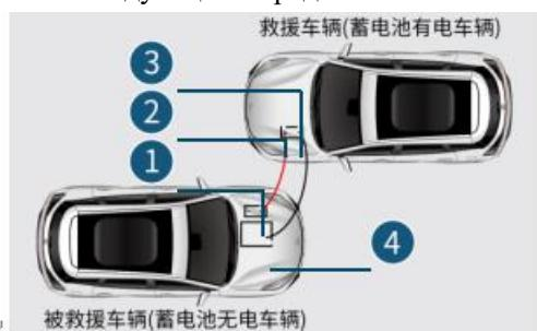
1. Подсоедините один конец красного плюсового (+) кабеля к положительному (+) выводу **1** разряженной аккумуляторной батареи автомобиля.
