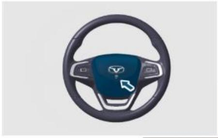
Звуковой сигнал автомобиля служит для предупреждения других участников дорожного движения в особых дорожных ситуациях в целях обеспечения безопасности и предотвращения дорожно-транспортных происшествий. Независимо от состояния включения зажигания звуковой сигнал подается путем нажатия на область рулевого колеса, отмеченную значком звукового сигнала.
