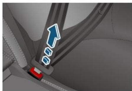
3. Потяните ремень безопасности в противоположном направлении, чтобы убедиться в надежной фиксации ремня безопасности в замке.
