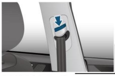
1. Нажмите кнопку регулятора ремня безопасности по высоте и, взяввшись за регулятор, перемещайте его вниз до нужного положения.
