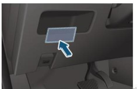
Блок предохранителей находится за левой нижней облицовкой передней панели. Для проверки и замены предохранителей снимите крышку на левой нижней облицовке передней панели.
