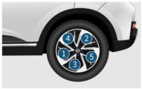
6. Установите докатное колесо и колесные болты. При установке колесных болтов сначала вкрутите их от руки, насколько возможно, равномерно затяните предварительным моментом с помощью баллонного ключа.
