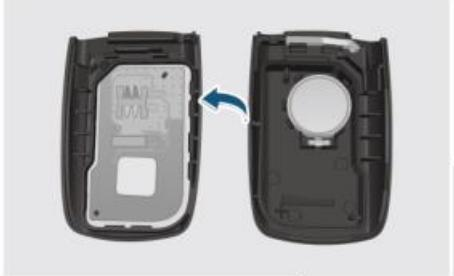
2. Отделите крышку пульта смарт-ключа с помощью отвертки с плоским лезвием, обернутым изолентой, и извлеките печатную плату.
