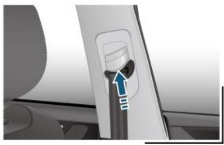
1. Нажмите кнопку регулятора ремня безопасности по высоте и, взяввшись за регулятор, перемещайте его вверх до нужного положения.
