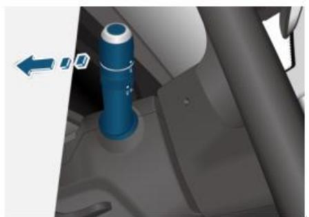
При включенном ближнем свете переведите переключатель освещения в крайнее положение в направлении от рулевого колеса, включится дальний свет, и загорится контрольная лампа
