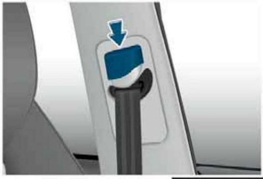
1. Нажмите кнопку регулятора ремня безопасности по высоте и, взявшись за регулятор, перемещайте его вниз до нужного положения.
