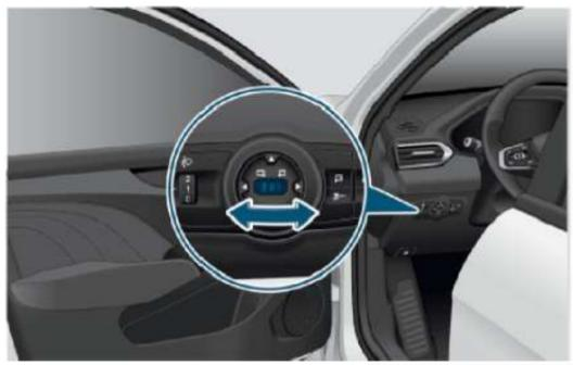
Перед началом движения автомобиля наружные зеркала заднего вида можно отрегулировать под нужным углом следующим образом.
