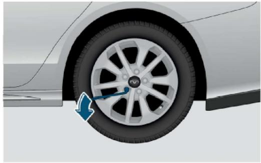
1. Баллонным ключом ослабьте колесные болты поворотом против часовой стрелки на один-два оборота.
