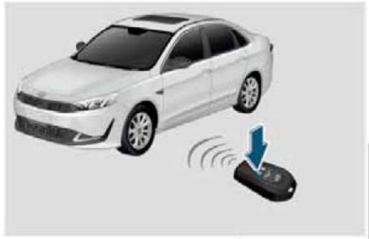
В радиусе действия дистанционного управления, когда зажигание выключено (положение «OFF») и двери закрыты (включая крышку багажного отсека), нажмите коротко кнопку запираения на пульте дистанционного управления ключа, все двери запираются, однократно прозвучит сигнал и 3 раза мигнут указатели поворота, одновременно загораются дневные ходовые огни и габаритные огни\*.
