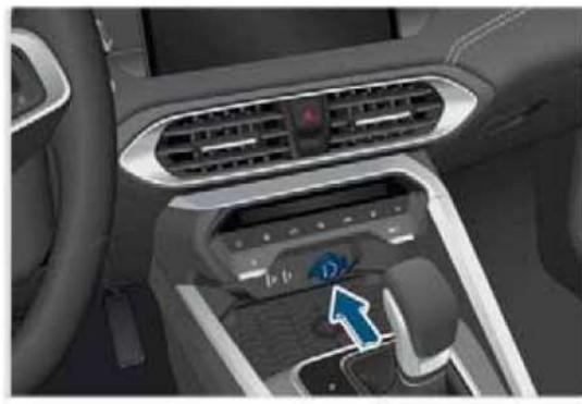
При включенном зажигании (положение «ON» или «ACC») откройте крышку разъема электропитания и подключите устройство для зарядки.
