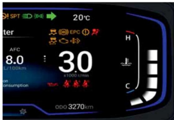
Указатель температуры охлаждающей жидкости (комбинация приборов с дисплеем 7 дюймов)
