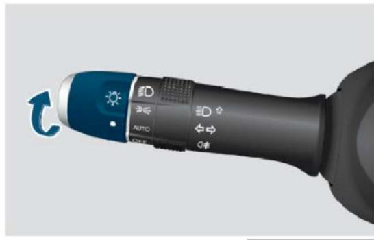
Поверните переключатель освещения в положение «AUTO» – ближний свет, габаритные и индикаторные огни на приборах будут включаться автоматически с наступлением темноты. При достаточном освещении окружающего пространства световые приборы будут автоматически выключаться.
