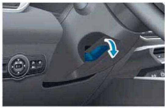
Регулировка рулевого колеса может сделать управление автомобилем удобнее для людей разного роста и телосложения. Перед началом движения автомобиля отрегулируйте положение рулевого колеса в соответствии со своими потребностями.
