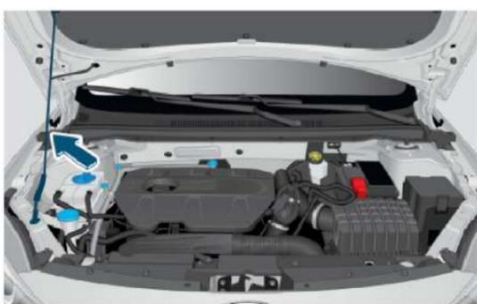
3. Поднимите капот и подставьте упор, чтобы надежно зафиксировать его.
