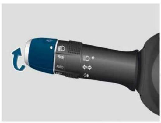
При включенном зажигании (положение «ON») поворотом переключателя освещения в положение
