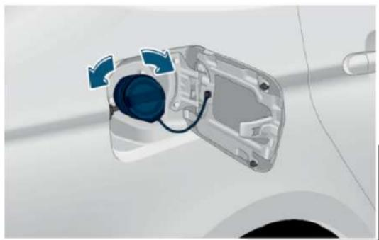
2. Медленно поверните пробку заливной горловины против часовой стрелки, открутите и снимите её.
