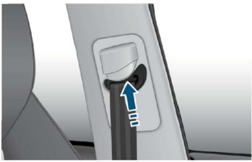
1. Нажмите кнопку регулятора ремня безопасности по высоте и, взявшись за регулятор, перемещайте его вверх до нужного положения.
