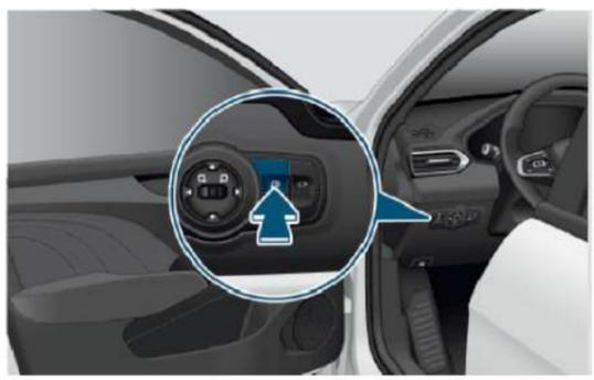
При необходимости наружные зеркала заднего вида могут быть сложены с помощью клавиши складывания наружных зеркал заднего вида.
