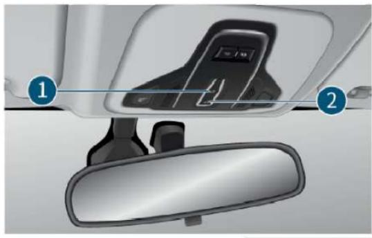
Управление панорамным люком в крыше доступно при включенном зажигании (положение «ON»).
