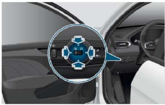
2. Нажимайте клавишу регулировки наружных зеркал заднего вида для установки зеркала в положение наилучшего обзора назад.
