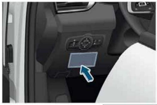
Блок предохранителей находится за левой нижней облицовкой передней панели. Для проверки и замены предохранителей снимите крышку на левой нижней облицовке передней панели.
