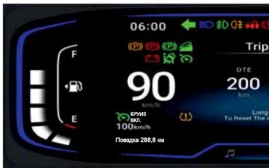
Спидометр\* (комбинация приборов с дисплеем 7 дюймов)
