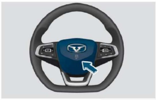
Звуковой сигнал автомобиля служит для предупреждения других участников дорожного движения в особых дорожных ситуациях в целях обеспечения безопасности и предотвращения дорожно-транспортных происшествий. Независимо от того, включено зажигание или выключено, звуковой сигнал подается путем нажатия на область рулевого колеса, отмеченную значком звукового сигнала.
