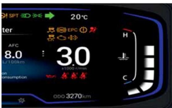
Тахометр (комбинация приборов с дисплеем 7 дюймов)
