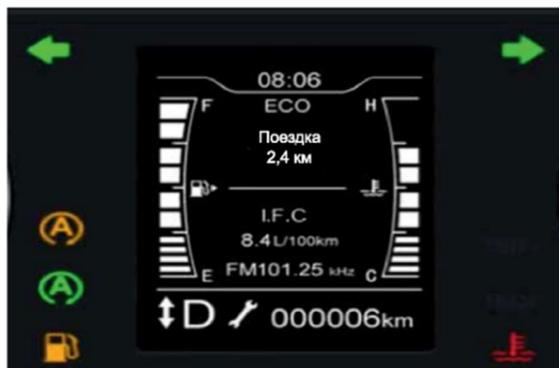
Указатель температуры охлаждающей жидкости (комбинация приборов 3,5 дюйма)
