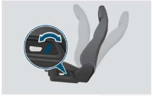
**◆ Регулировка угла наклона спинки сиденья**
