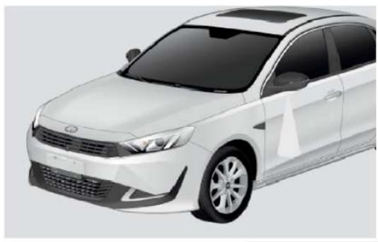
При отпирании дверей автомобиля или открытии передней двери автоматически загорается лампа подсветки, расположенная на наружном зеркале заднего вида.
