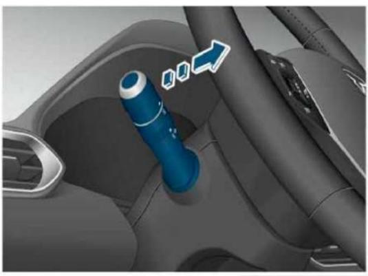
Потяните переключатель освещения назад в крайнее положение в направлении рулевого колеса, включится дальний свет. После отпускания переключатель освещения автоматически возвращается в исходное положение и дальний свет выключается.
