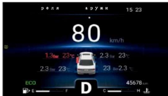
Если давление в шинах слишком низкое, в комбинации приборов загорится сигнальная лампа системы контроля давления в шинах
