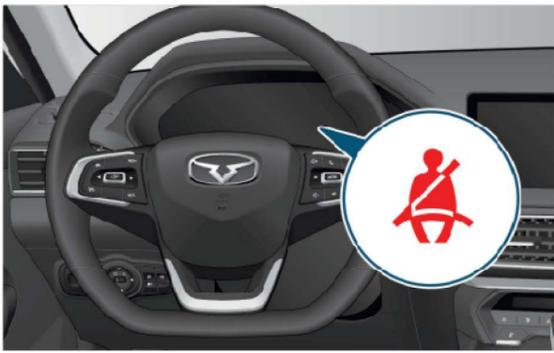
В этом автомобиле имеется сигнальная лампа непристегнутого ремня безопасности водителя и пассажиров, а также звуковой сигнализатор для напоминания о необходимости пристегнуть ремень безопасности. Подробная информация содержится в разделе «Оборудование автомобиля и управление», пункт «Сигнальные и контрольные лампы». [↗ страница 26](#)
