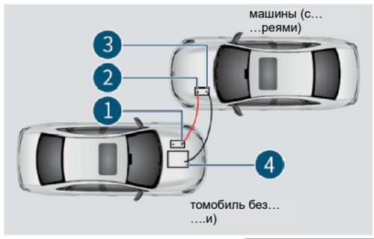
1. Подсоедините один конец красного плюсового (+) кабеля к положительному (+) выводу ① разряженной аккумуляторной батареи автомобиля.
