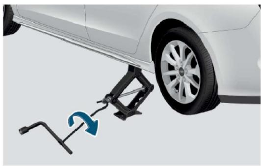
3. Вставьте рукоятку домкрата, вставьте баллонный ключ в рукоятку домкрата. Поворачивая рукоятку баллонным ключом по часовой стрелке, медленно поднимите автомобиль домкратом до отрыва колеса от земли.
