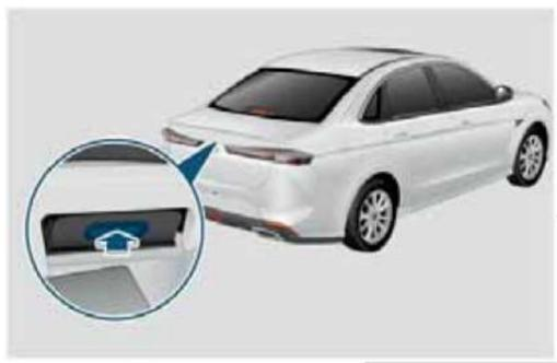
Когда автомобиль заперт, поднесите смарт-ключ с пультом дистанционного управления к крышке багажного отсека и нажмите кнопку микропереключателя, чтобы открыть крышку багажного отсека.
