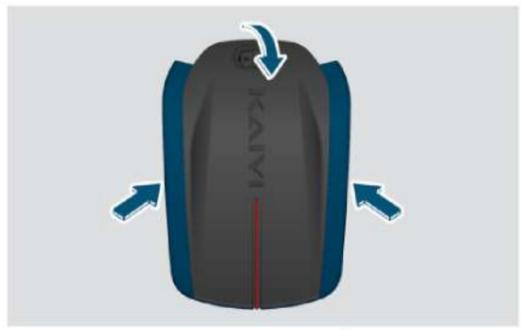
2. Отделите крышку пульта смарт-ключа с помощью отвертки с плоским лезвием, обернутым изолентой.
