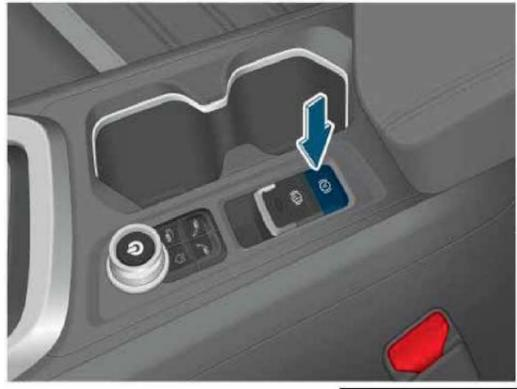
Если выполнены условия начала действия функции AUTO HOLD, для включения функции нажмите клавишу AUTO HOLD. Индикатор в клавише загорится, указывая на то, что функция AUTO HOLD включена.
