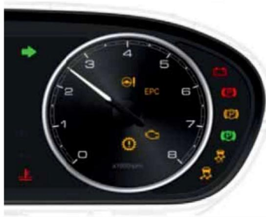
Тахометр (комбинация приборов с дисплеем 3,5 дюйма)
