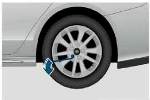
4. Выкрутите колесные болты и снимите поврежденное колесо.
