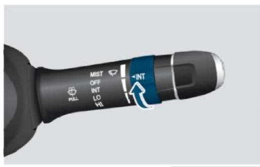
◇ Поворачивая переключатель чувствительности стеклоочистителя можно установить любое из четырех значений интервала срабатывания щеток: 2, 4, 8 или 13 секунд.
