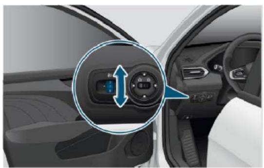
◆ Положение кузова меняется в зависимости от загрузки автомобиля, в процессе разгона или торможения и т. д. Направление пучка ближнего света соответственно можно регулировать с помощью корректора фар.
