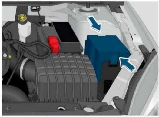
Блок предохранителей находится в левой задней части моторного отсека. Для проверки и замены предохранителей откройте капот, нажмите на защелки с обеих сторон крышки блока предохранителей, одновременно потяните вверх крышку блока предохранителей.
