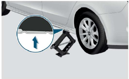
2. Установите домкрат под опорную точку рядом с заменяемым колесом. Убедитесь, что домкрат установлен на ровной и твердой горизонтальной поверхности.
