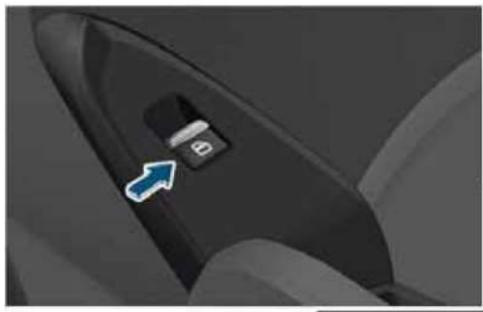
При включенном зажигании (положение «ON») (или в течение 2 минут после выключения зажигания (положение «OFF») и при закрытых обеих передних дверях) клавишей на двери переднего пассажира можно управлять стеклоподъемниками.
