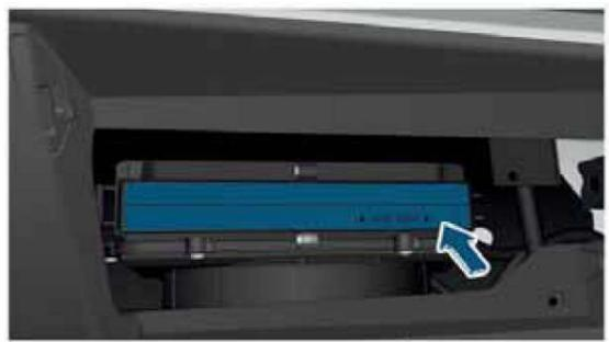
2. Нажмите на фиксатор крышки салонного фильтра и снимите крышку.
