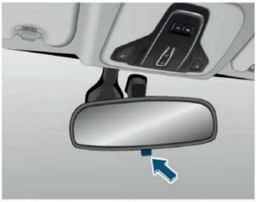
Если свет автомобиля, следующего сзади, слишком яркий, можно отклонить зеркало за рычажок в нижней части корпуса внутреннего зеркала заднего вида, чтобы предотвратить ослепление водителя.
