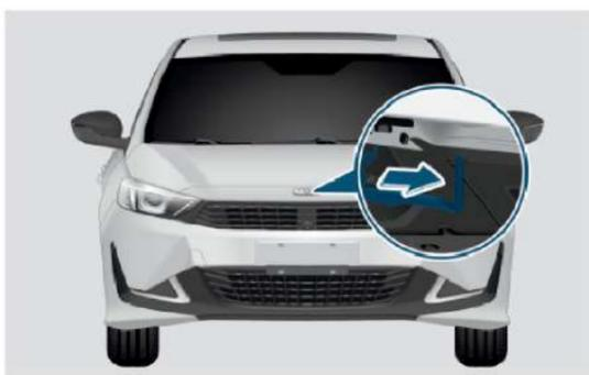
2. Подсуньте пальцы под край в средней части капота и поверните вправо предохранительный рычаг замка и поднимите капот.
