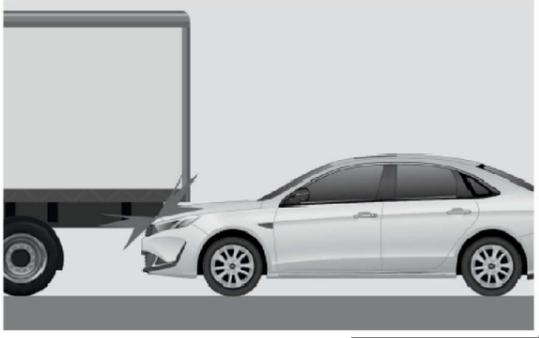
◇ Столкновение с подкатом под заднюю часть грузового автомобиля.
