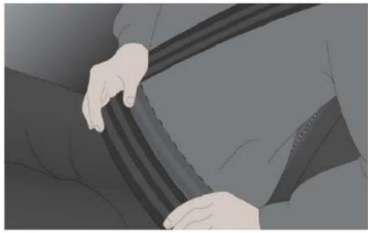
2. Медленно и плавно вытяните ремень безопасности из втягивающего устройства, накиньте его поверх груди и бедер, а затем вставьте язычок ремня в замок до фиксации со щелчком.
