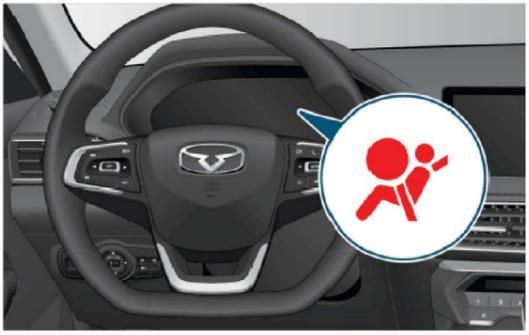
В автомобиле имеется сигнальная лампа, предупреждающая водителя о неисправном состоянии системы подушек безопасности. Подробная информация содержится в разделе «Оборудование автомобиля и управление», пункт «Сигнальные и контрольные лампы».
