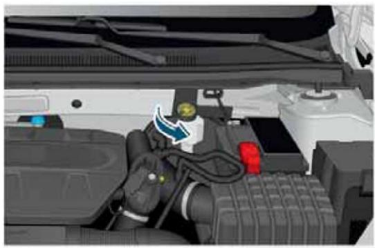
1. На холодном двигателе открутите против часовой стрелки крышку компенсационного бачка для тормозной жидкости.
